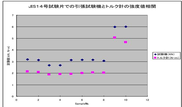
図表4 JIS14号試験片による引張試験とトルク試験
