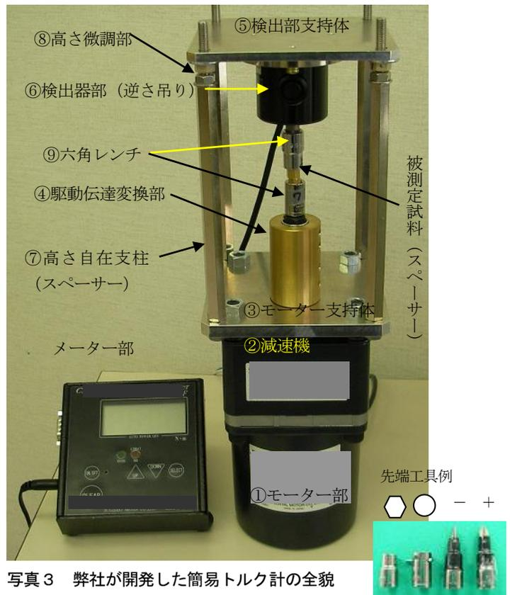
写真3 弊社が開発した簡易トルク計の全貌
