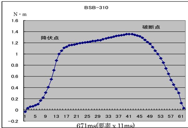
図表1 簡易トルク計によるトルク強度測定例(PC出力)
