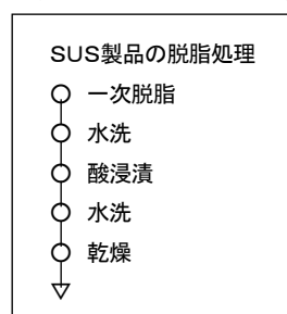
図1. SUS 製品の脱脂
