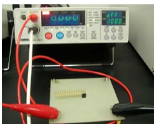
写真3 絶縁抵抗試験
